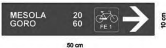
Fig 2: Segnale di direzione ottenuto dai segnali turistici per contesti urbani (riduzione da segnale tabella II 13a DPR 495/92)
